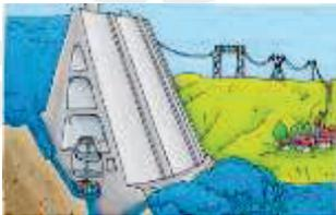
El agua de los desniveles naturales de los ríos o de los embalses contruidos por el ser humano a grandes alturas tiene energía potencial. Cuando esta agua cae, su energía potencial se transforma en energía cinética. Esa energía cinética puede ser aprovechada para activar una rueda, por ejemplo, de un molino o para generar energía eléctrica.
