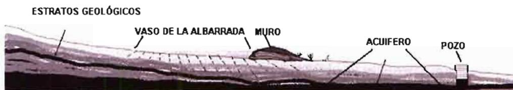
MECÁNICA DE LA RECARGA DE UN ACUÍFERO MEDIANTE ALBARRADAS
