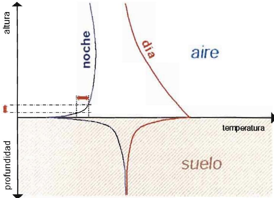
Figura 16: Perfiles de temperatura por cielo despejado en el Altiplano
