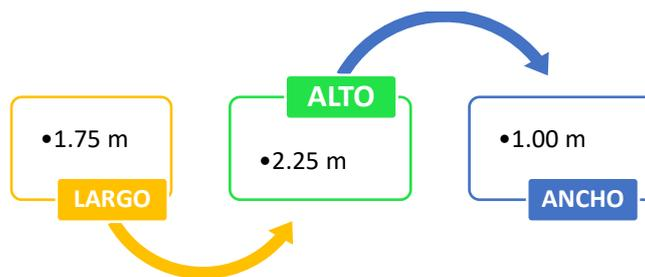
El ancho representa 60 centímetros (ancho del volante) y 20 centímetros de espacio necesario para el movimiento de brazos. A ello, se deben añadir 25 centímetros a cada lado para resguardo del ciclista. El Manual bogotano recomienda que la altura deba ser de 2.50m como se ilustra en la figura 2.8:
